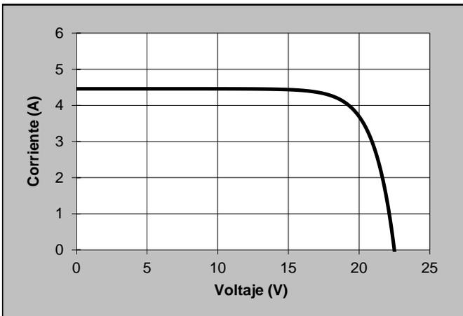
Los valores y la curva están dados para las condiciones de insulación de 1 KW/m<sup>2</sup>, masa atmosférica 1.5 y temperatura de celda de 25°C.
