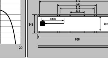
Los valores y la curva están dados para las condiciones de insolación de 1 KW/m2, masa atmosférica 1.5 y temperatura de celda de 25°C. Potencia Mínima Garantizada = Potencia Nominal - 10 %
