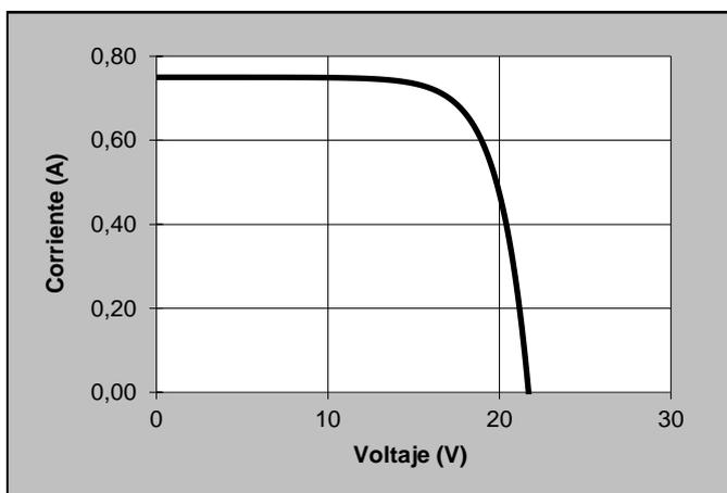
Los valores y la curva están dados para las condiciones de insolación de 1 KW/m<sup>2</sup>, masa atmosférica 1.5 y temperatura de celda de 25°C.
